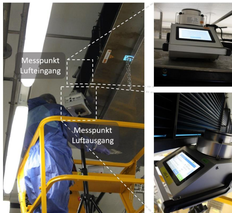
Abb. 2: Luftkeimmessungen am Verdampfer: möglichst nahe am Lufteingang und direkt vor der Verdampferlamelle (Luftauslass).
